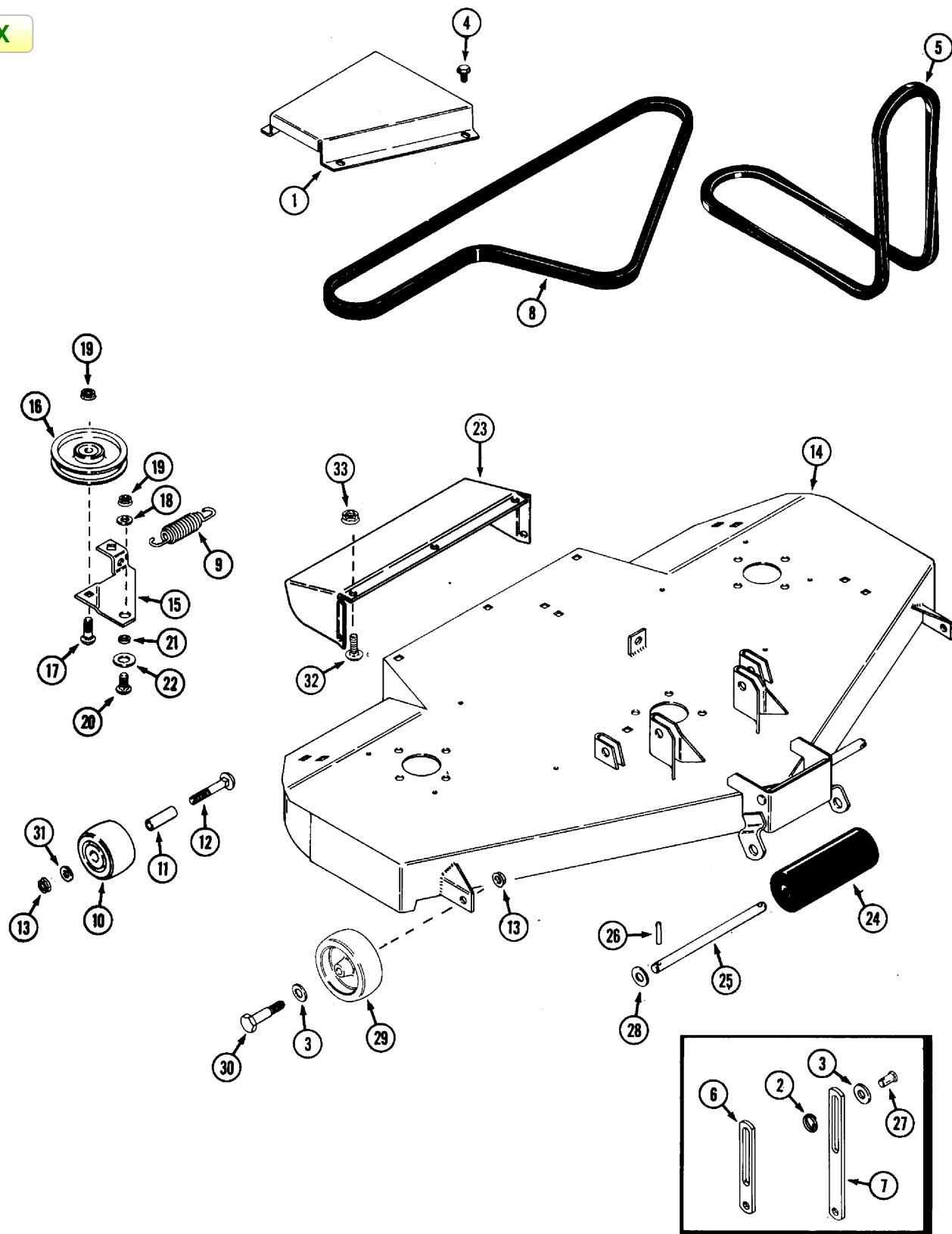
**INDEX****DECK, BELTS AND BACKSIDE IDLER PULLEY**
