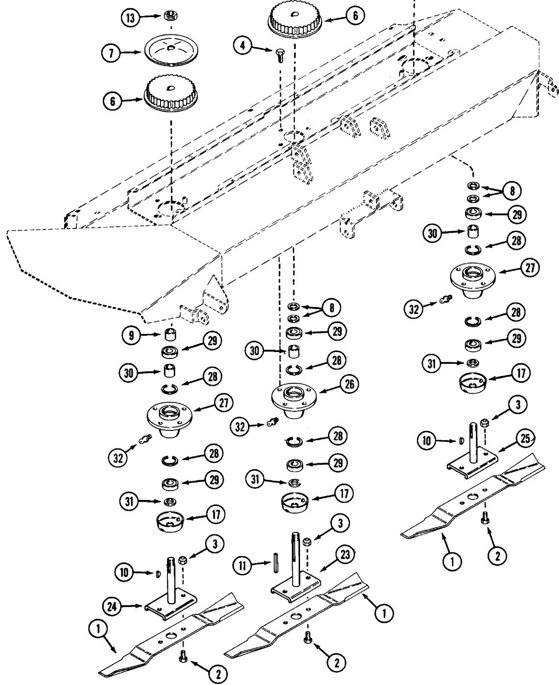
**PULLEYS, BLADES AND SPINDLES**
