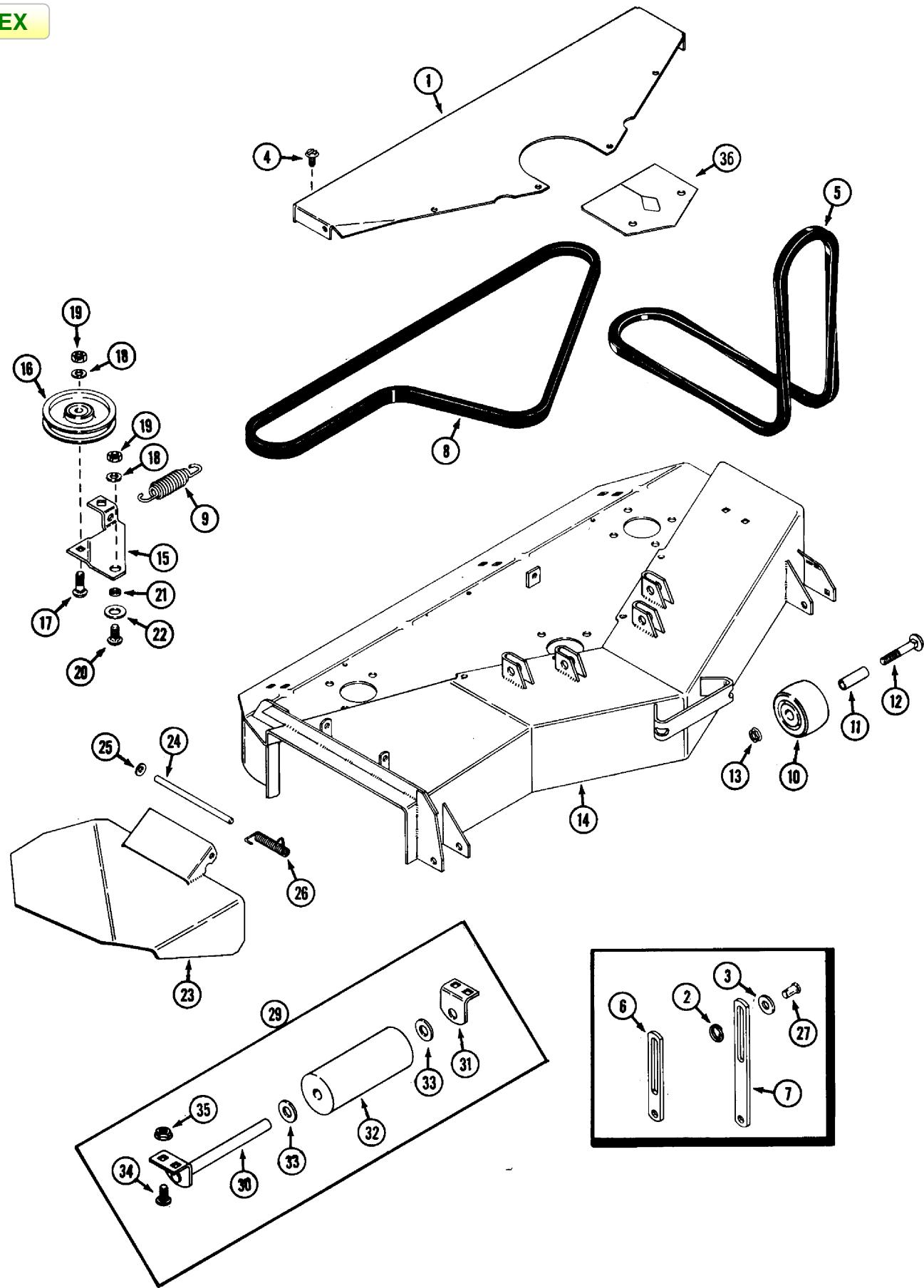
**INDEX****DECK, BELTS AND BACKSIDE IDLER PULLEY**
